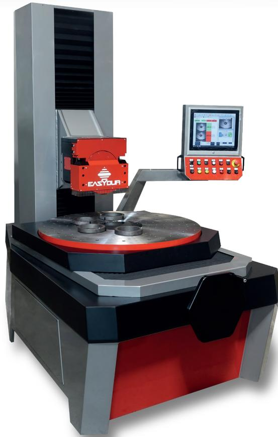
Integral Rotary a été conçu par Easydur comme un **duromètre de production** et il peut être considéré comme un îlot de travail puisqu'il est équipé d'un axe de test et d'une table rotative supplémentaire ainsi que d'un deuxième axe Y pour déplacer la table rotative d'avant en arrière par rapport à la tête.
