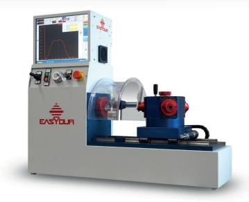
Questo torsiometro è dotato di computer con touch screen per l'esecuzione delle ricette di prova. Disponibili modelli da banco o autoportanti da terra. **Semplicità d'uso**
